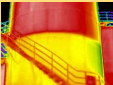
对储罐液位线进行快速二次校验
