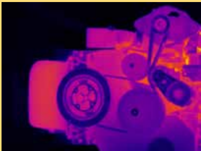
对发动机的散热系统、排气系统、传动系统进行热分布检测，改善设计布局
