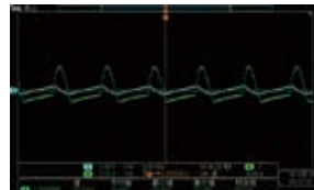
CV 50V 低速模式： 可以明显看出震荡现象
