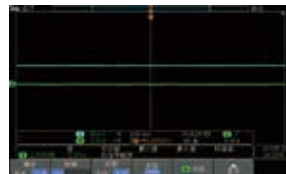
CV 50V 高速模式： CV稳定，无震荡现象
